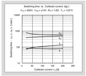
Fig. 2-6 Switching time -  $I_{\rm C}$  characteristics  $(T_{\rm vi}=125^{\rm o}{\rm C})$
