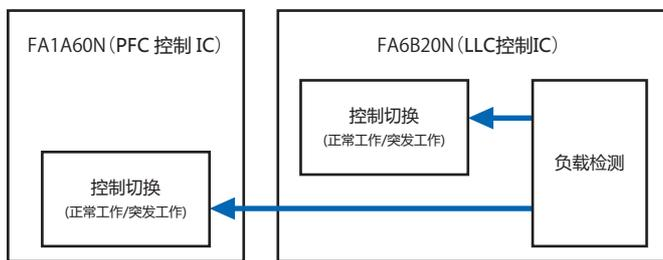
※1 临界模式PFC控制IC FA1A60N和LLC电流谐振控制IC FA6B20N可以组合使用也可以单独搭配其它IC使用。
