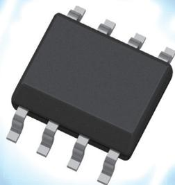
AC/DC 用PWM 控制IC FA8A80/90 系列为反激电路提供最适合的系统。
