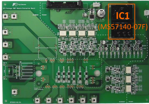
(1) Attach IC1 (MS57140-07F)
