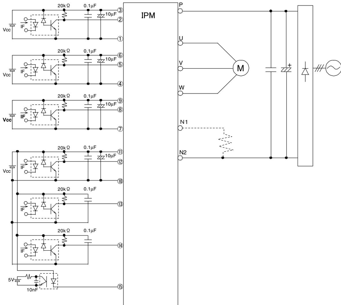
图 4-6 小容量 IPM P619 应用电路示例
