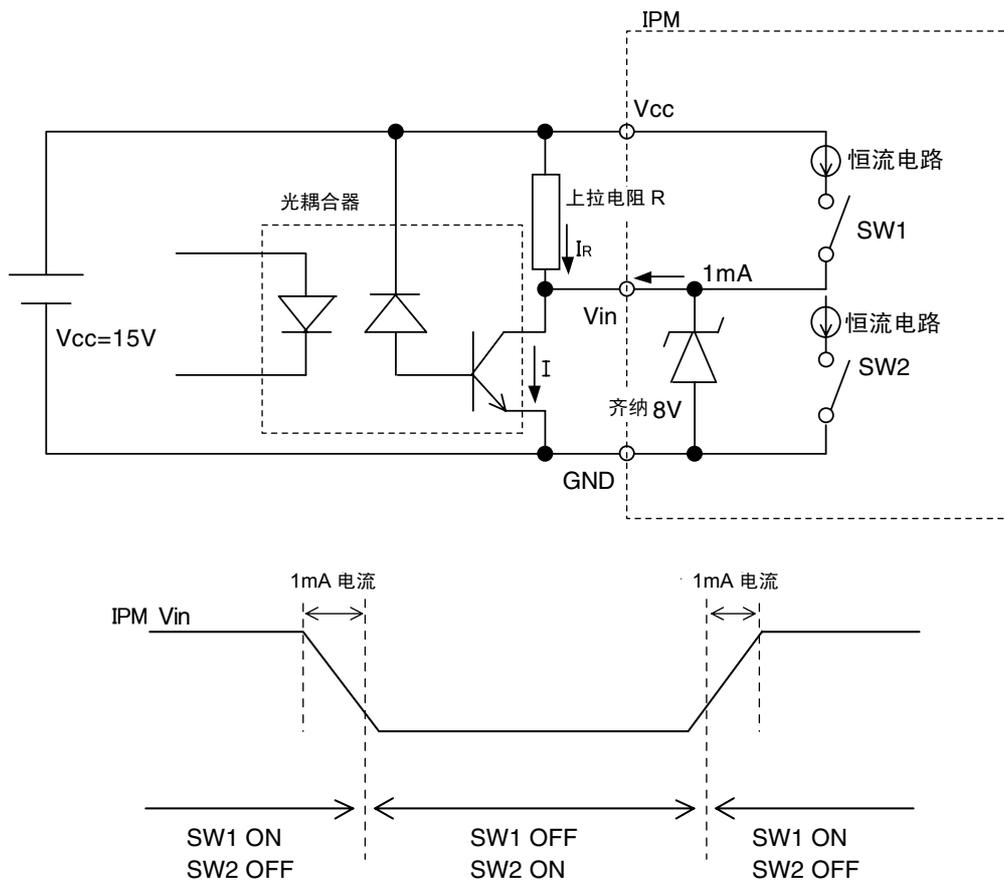
图 4-7 IPM 输入电路和恒流动作时序
