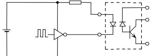
图 4-8 光耦合器输入电路
