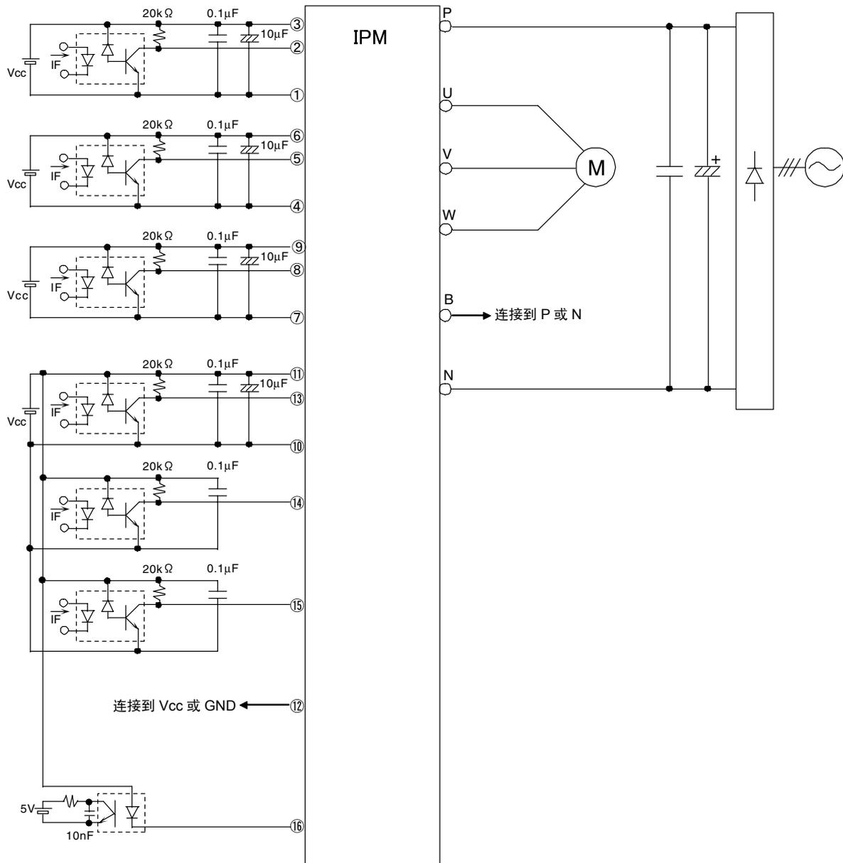
图 4-2 P610、P611、P612 应用电路示例（制动电路内置型）
