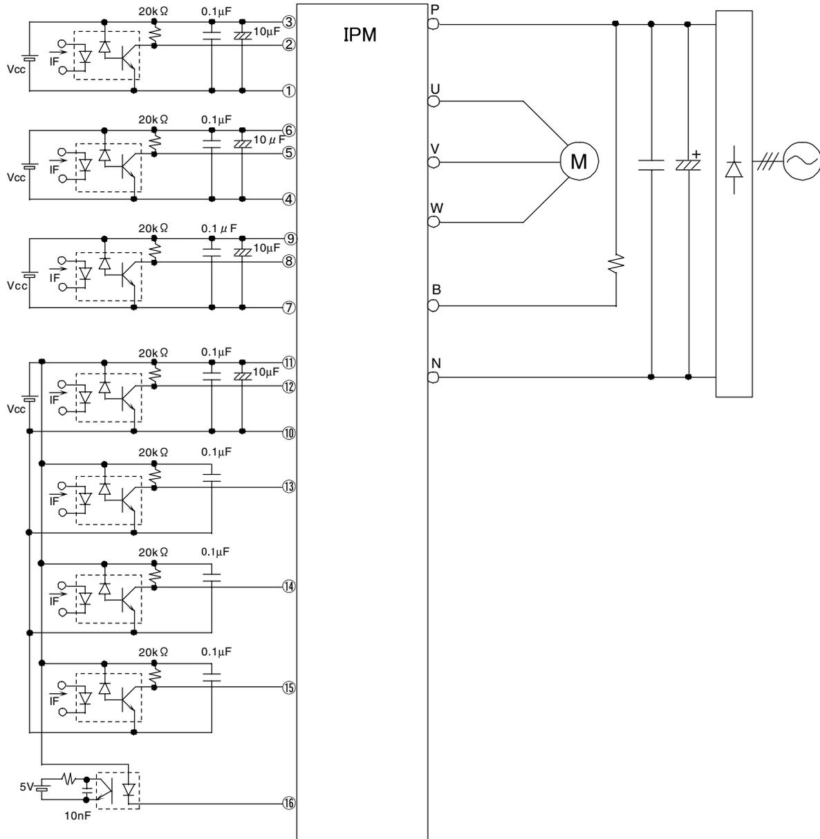
图 4-1 P610、P611、P612 应用电路示例（制动电路内置型）
