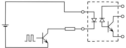
良例: 在晶体管 C-E 之间将光电二极管 A-K 之间短路
