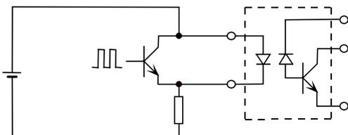
不良例: 在光电二极管阳极一侧接限流电阻
