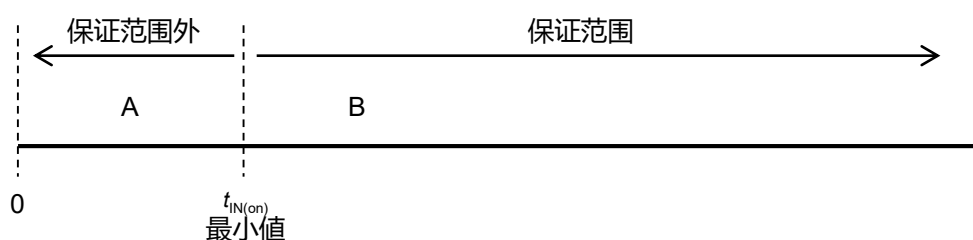
图.3-17 IGBT 驱动状态和输入信号的开通脉宽
