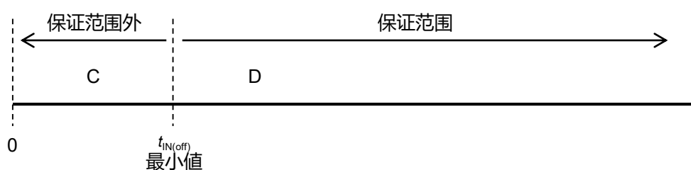
图.3-18 IGBT 驱动状态和输入信号的关断脉宽
